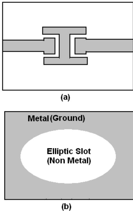
Fig. 3. a) Top Layer, b) Bottom Layer
