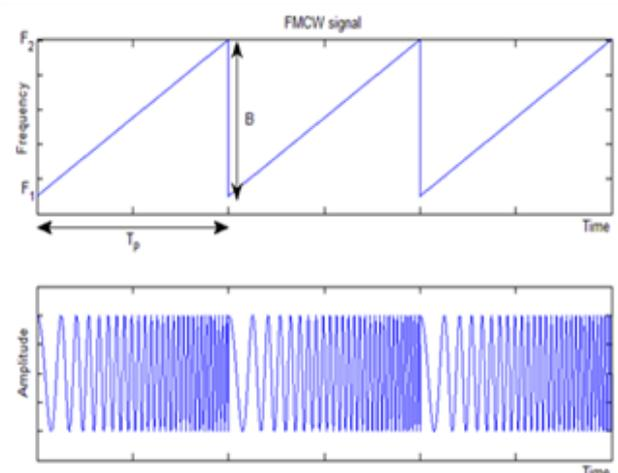
Fig. 2 FMCW waveform
