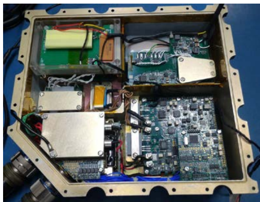
Fig. 3 EPC Modules Assembly
