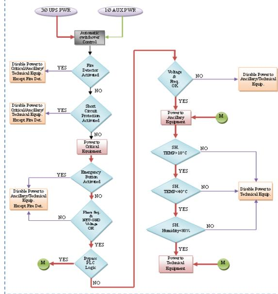
Figure 7 : PLC Process Flowchart
